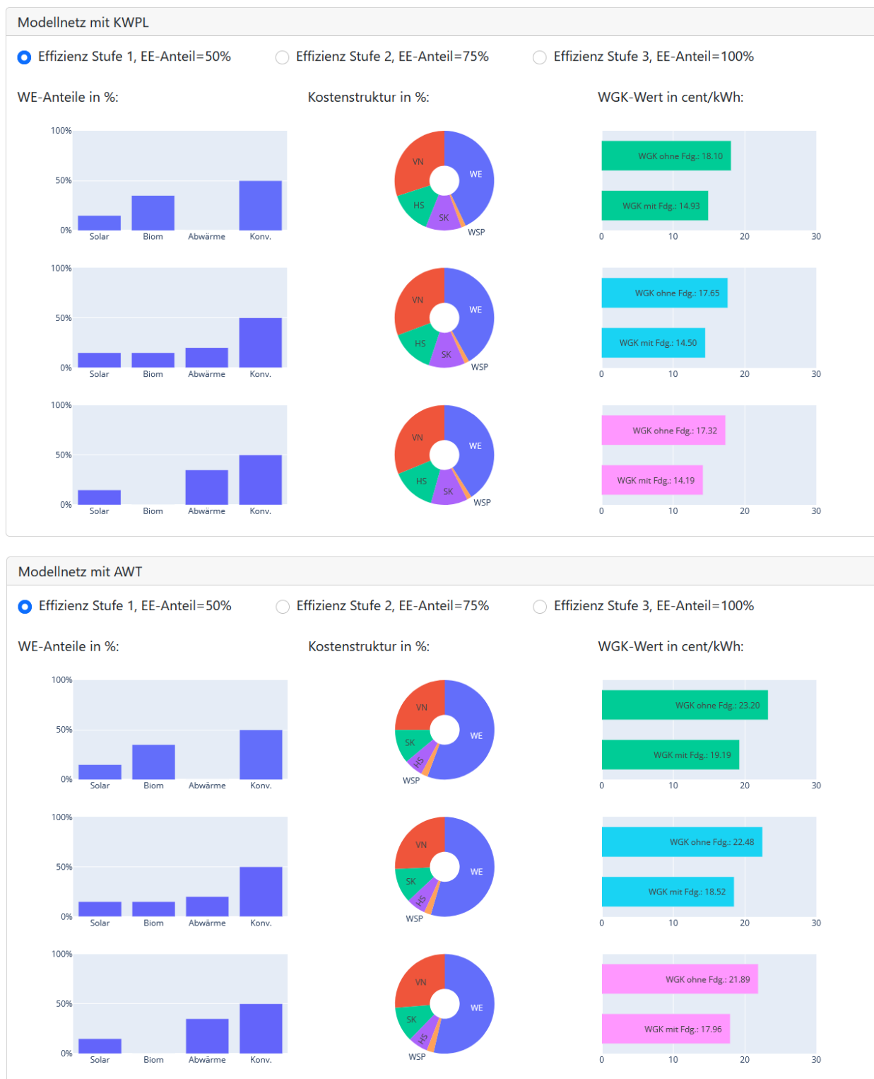
Abbildung 1-28: WGK-Vergleich bei verschiedener Effizienz Stufe, oben: Modellnetz mit KWPL; unten: Modellnetz mit AWT
