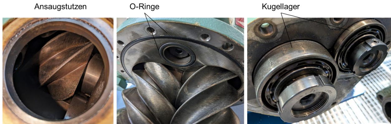
Abbildung 1-53: Wartung des Bitzer OSKA5341-K Schraubenverdichters
