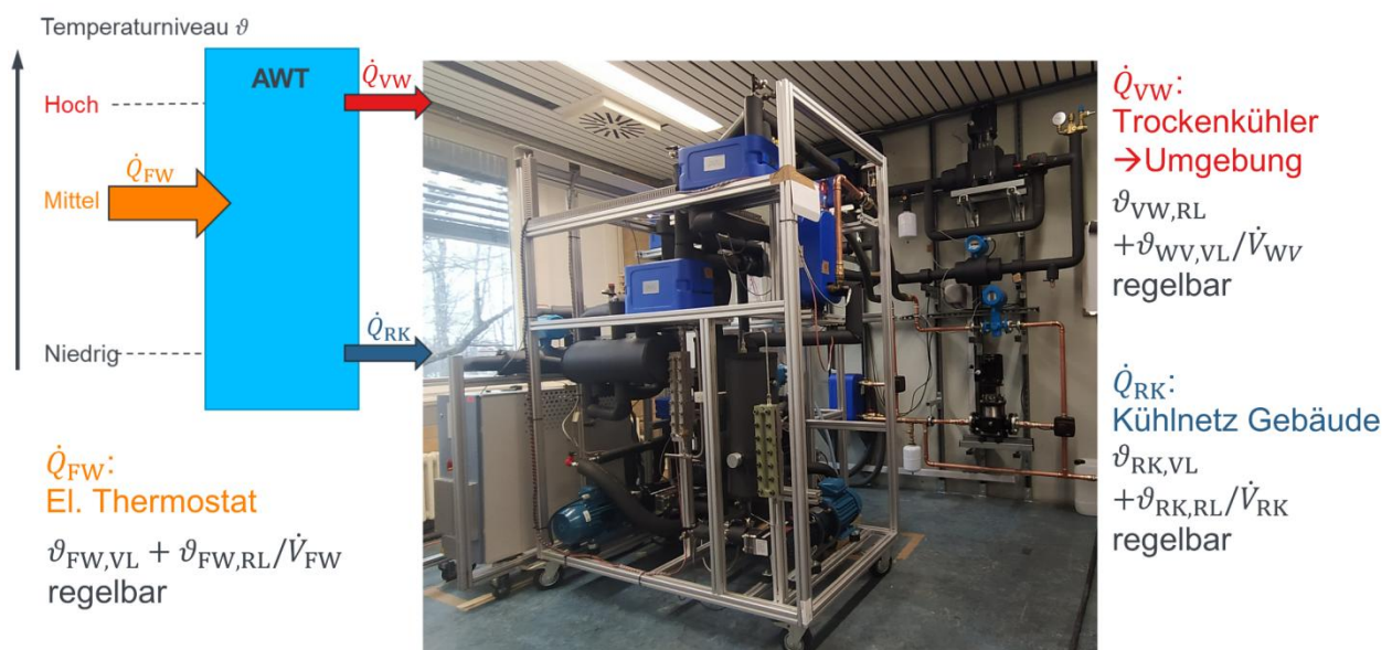
Abbildung 1-32: AWT inklusive Prüfstand
