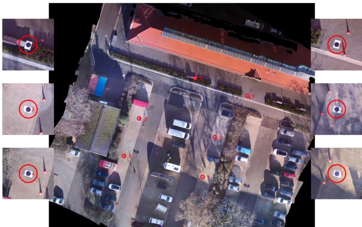
Abbildung 2-9 Optisches Orthomosaik des untersuchten Gebiets mit den durch rote Kreise markierten GCPs
