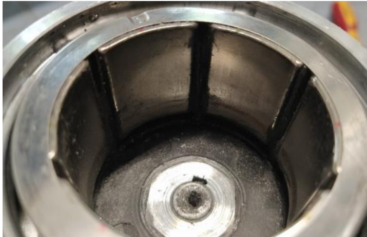
Abbildung 3-18: Geöffnete Magnetkupplung mit sichtbaren Abriebspuren.
