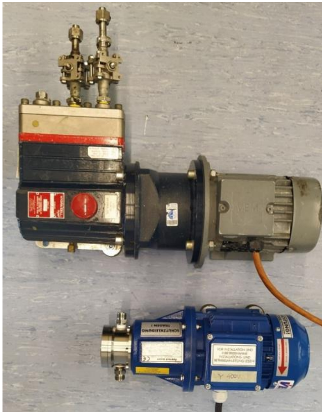
Abbildung 3-22: Größenvergleich der Kolbenmembranpumpe mit der Flügelzellenpumpe von Ventaix
