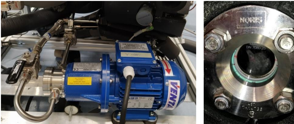
Abbildung 3-29: Links: Flügelzellenpumpe für Testbetrieb in die AWP eingebaut. Der Saugstutzen zeigt in den Vordergrund des Bildes. Rechts: Blick in den Pumpenvorlagebehälter – Lösung strömt von unten ein.
