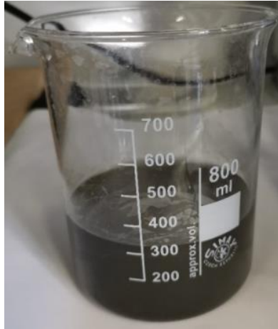
Abbildung 3-24: Durch Grafitabrieb grau verfärbte Ammoniakwasserlösung
