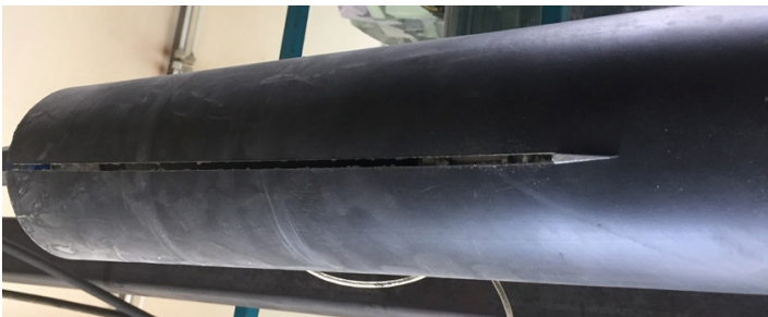
Bild 6 teilweise geschlitzte Ummantelung, Schlitzvorrichtung in der Ummantelung, Schlitzmesser sichtbar
