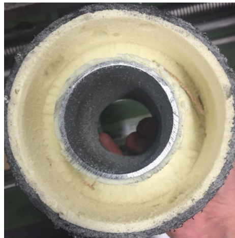
Bild 4 Schneidergebnis mit einer einzelnen Schneide
