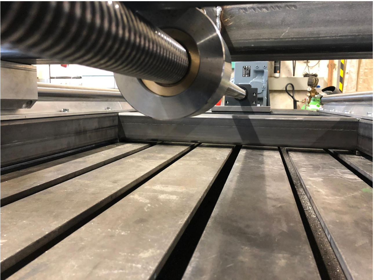
Bild 12 Gewindespindel, in der Spindelmutter laufend
