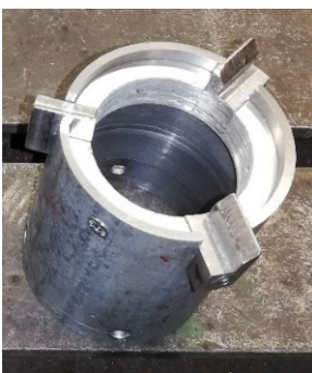
Bild 24 Bohrkopf nach der ersten Optimierung
