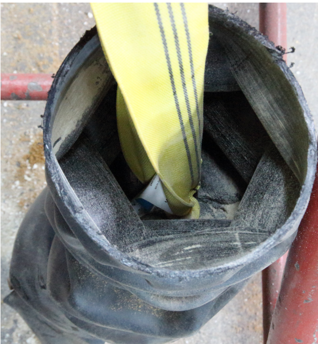
Bild 91 fest geklemmte Rundschlinge im aufgefalteten Bereich der Ummantelung
