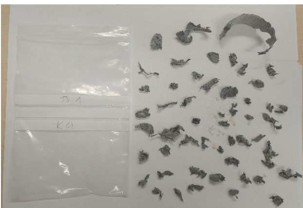
Bild 19 Teile der Abstandhalter aus dem Bohrklein
