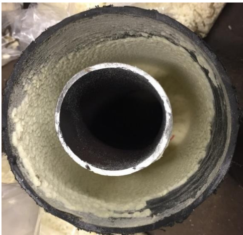
Bild 3 Schneidergebnis mit drei Schneiden
