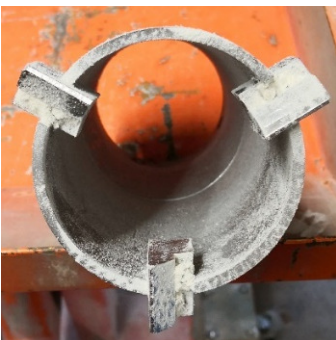
Bild 15 einfacher Bohrkopf mit drei Schneiden
