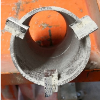
Bild 23 Bohrkopf vor der ersten Optimierung
