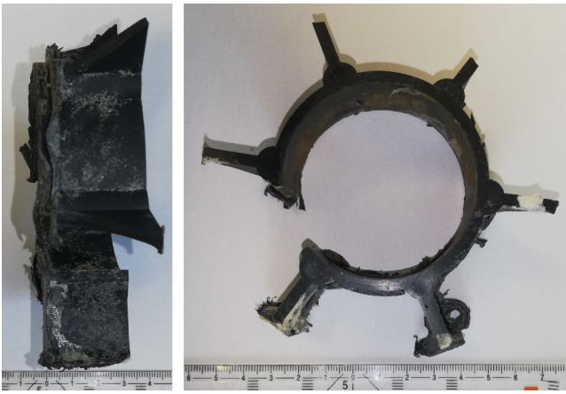
Bild 18 ausgebohrter Abstandhalter, Seitenansicht (links), Draufsicht (rechts)
