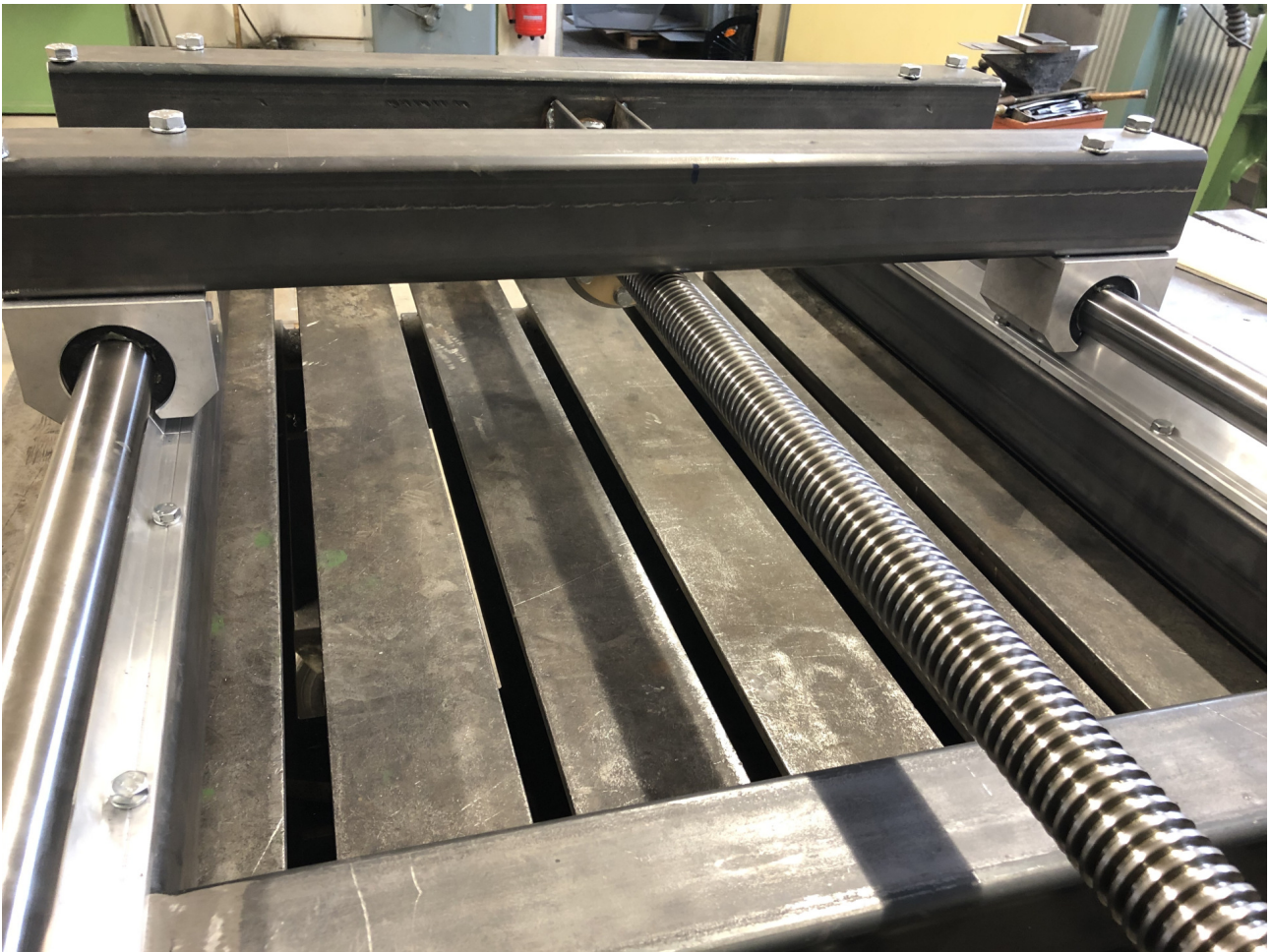
Bild 11 Schlitten mit Gewindespindel und Führungsschienen
