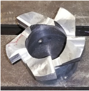
Bild 29 neuer Bohrkopf gemäß konstruktiver Vorgaben
