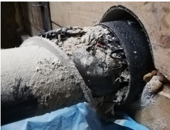
Bild 76 am Bohrgestänge anhaftendes Material der Ummantelung
