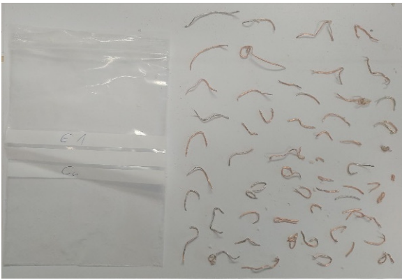
Bild 26 Teile der Leckwarndrähte aus dem Bohrklein
