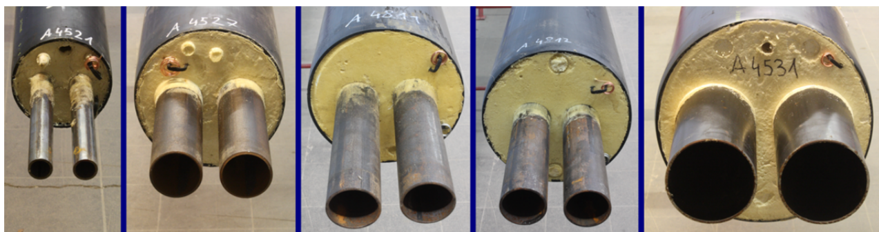
Bild 15 KMR, Hersteller 1; v. l. n. r. DN 20+DN 20/125; DN 50+DN 50/200; DN 50+DN 50/225; DN 50+DN 50/250; DN 100+DN 100/315
