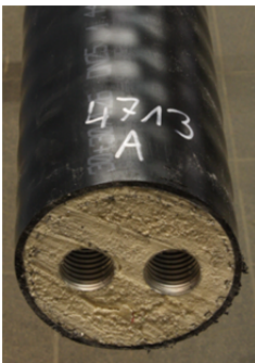
Bild 18 flexibles Verbundrohr mit Mediumrohren aus gewelltem rostfreiem Stahl; 30×0,3+30×0,3/126
