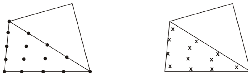
Abbildung 4-5: 15-Knoten-Dreieck-Element (links); 12 Gauß-Punkte (rechts) [4]
