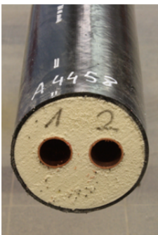
Bild 17 flexibles Verbundrohr mit Mediumrohren aus Kupfer; 28×1,2+28×1,2/110
