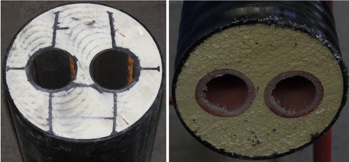
Bild 1 Doppelrohre, links Kunststoffmantelverbundrohr nach EN 15698, rechts flexibles Verbundrohr nach EN 15632
