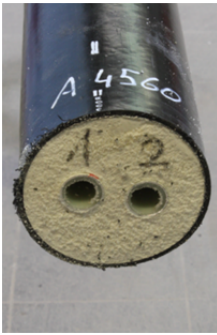
Bild 19 flexibles Verbundrohr mit Mediumrohren aus Mehrschichtverbund; 26×3,0+26×3,0/110
